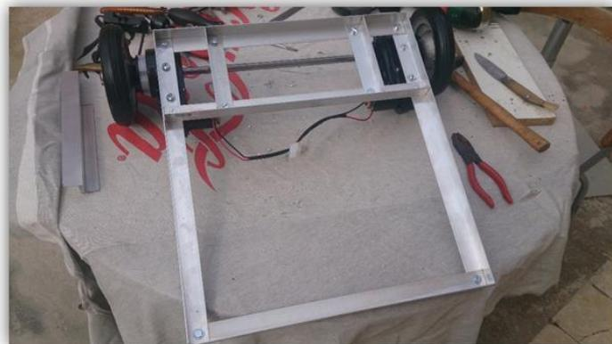
**Chasis con perfiles de refuerzo en la parte trasera (ya con los motores y ruedas traseras montados).**
