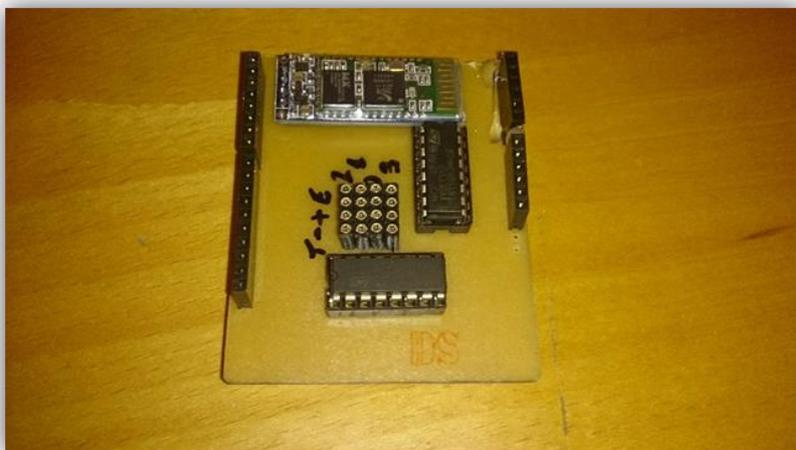
**Shield para Arduino con multiplexores y módulo Bluetooth.**
