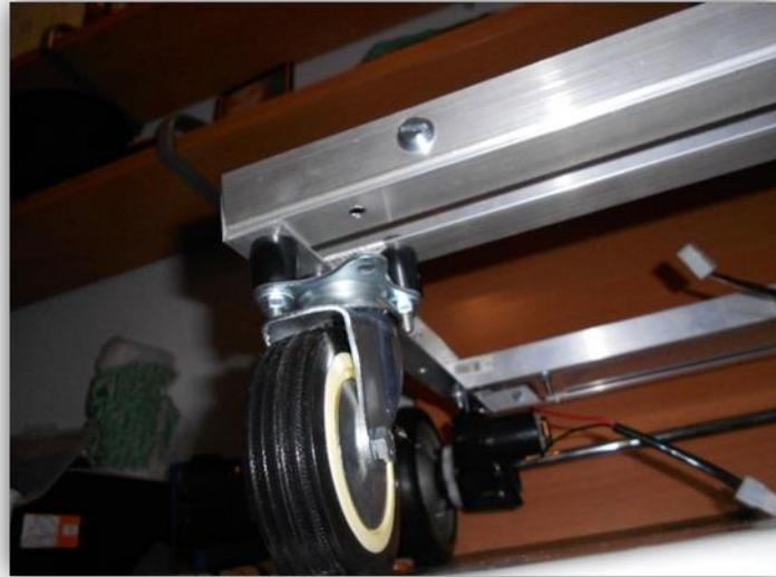
**Rueda delantera anclada a chasis usando tubitos separadores para conseguir el nivel.**
