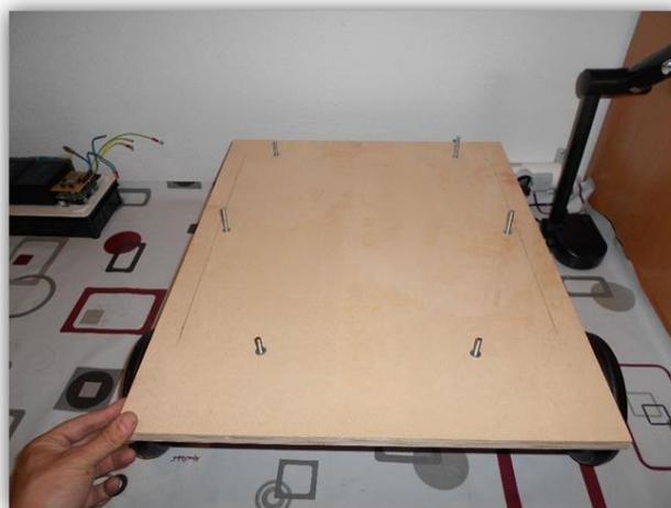
**Madera para la base con los 6 tornillos que irán al chasis (vista inferior de la madera).**
