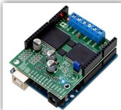
**Shield VNH5019 conectada a un Arduino Uno.**
