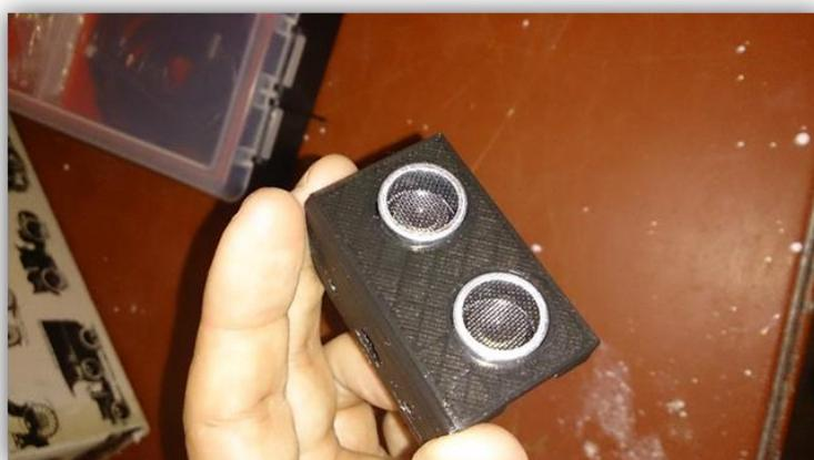
**Soporte con el sensor colocado.**
