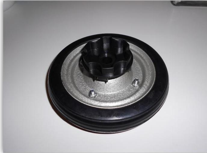
**Pieza acoplada a la rueda usando pegamento de soldadura plástica.**
