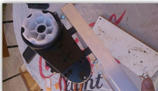
**Motor anclado al chasis con 2 tubitos de separación.**
