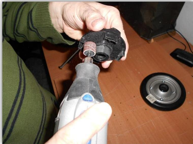
Lijado del eje de la pieza de acople rueda-motor.
