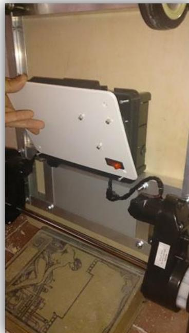
**Caja eléctrica colocada en la parte inferior del chasis, donde se puede ver el interruptor rojo colocado para el encendido/apagado.**
