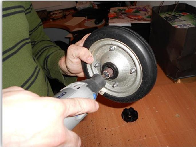
Lijado el interior del eje de la rueda.
