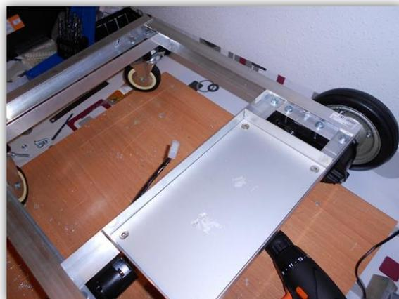
**Parte trasera del chasis con la plancha de aluminio de refuerzo (opcional).**
